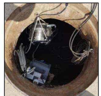
Im Schacht installiertes Probenahmemodul in der Ex-Version
