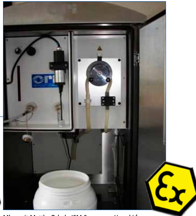
Mlog mit Mettler Toledo ISM Sensoren pH und Lf
